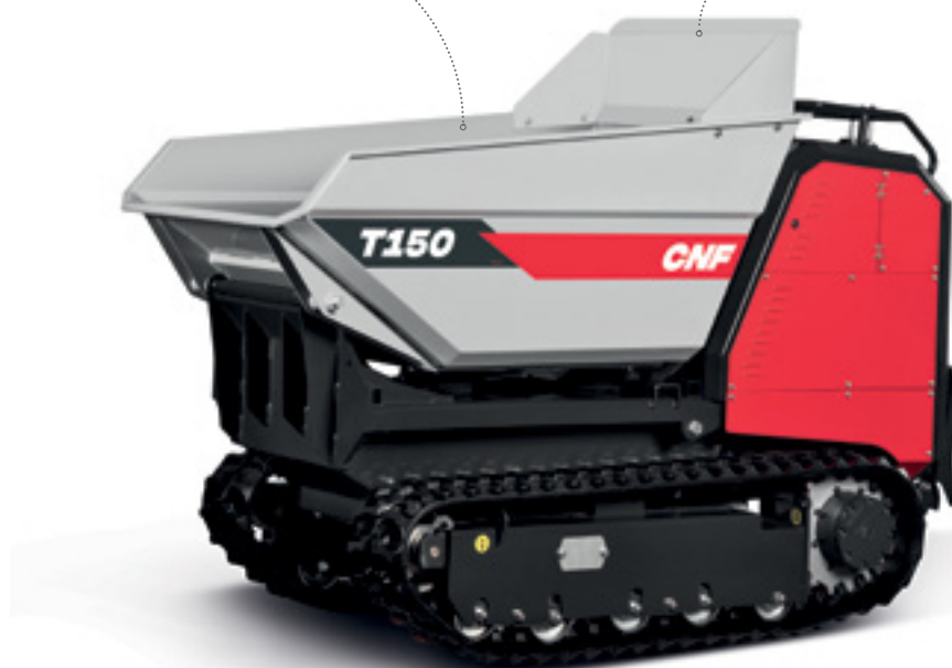
Sovraspando imbullonata Bolted overboard protection
